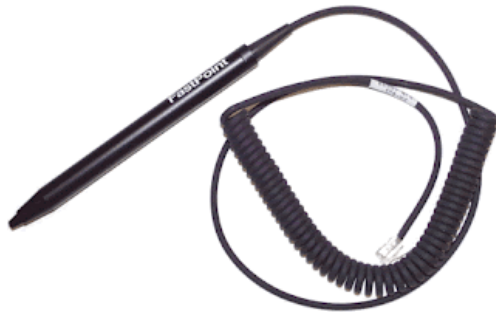
ภาพที่ 1.9 ปากกาแสง (Light Pen) ที่มา: Manusnan Komkhunthod, 2013
